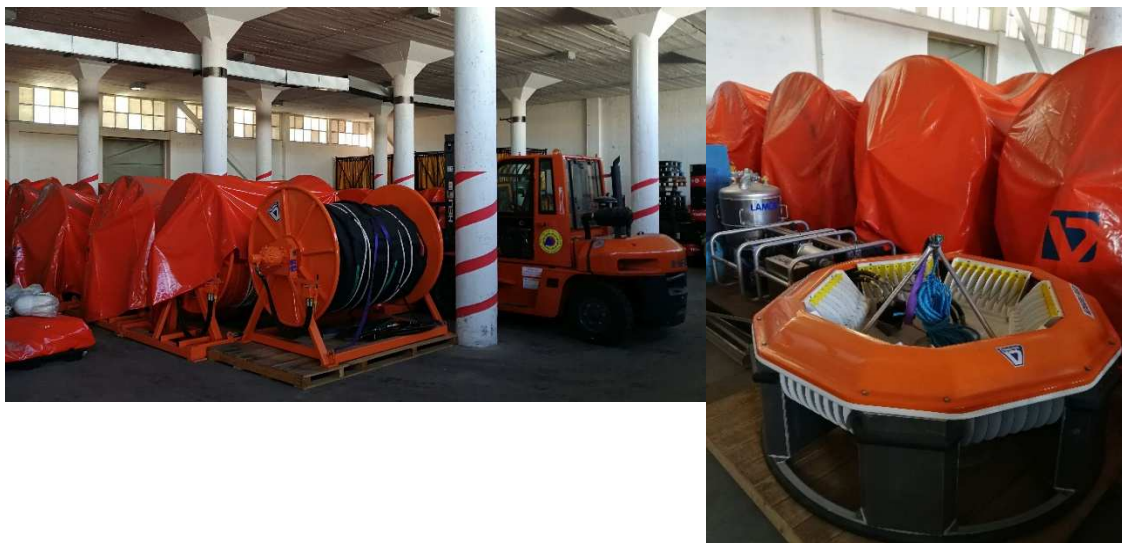
Slika 7 Koluti in vodne pregrade (levo) ter posnemovalec olj (desno)
